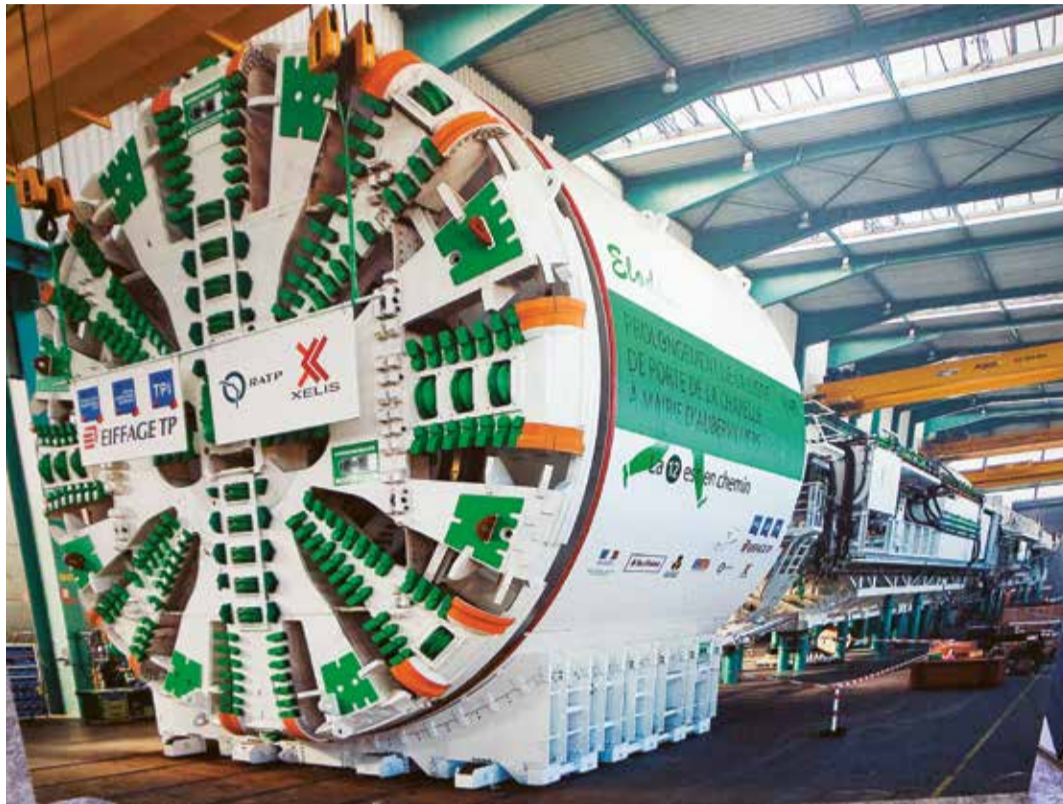
Utilisé pour le prolongement de la ligne 12 (RATP), le tunnelier Elodie mesure 82 mètres de long, 9 mètres de diamètre, pèse 1 400 tonnes et avance en moyenne de 12 mètres par jour. Un investissement de poids qui ne sera amorti qu'au bout de plusieurs chantiers. YANN CARADEC – 2011
